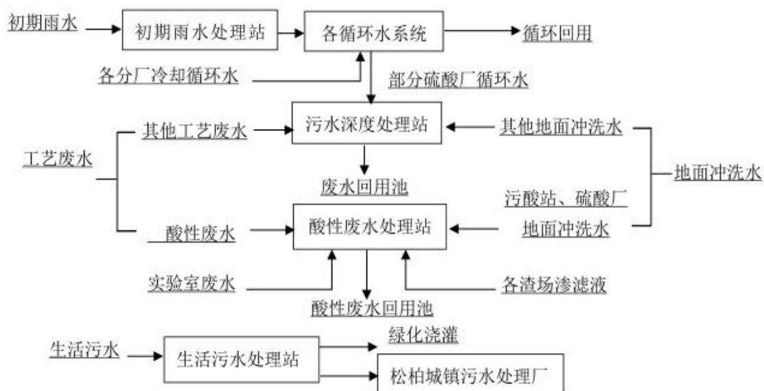
图 3.4-2 全厂废水走向示意图
