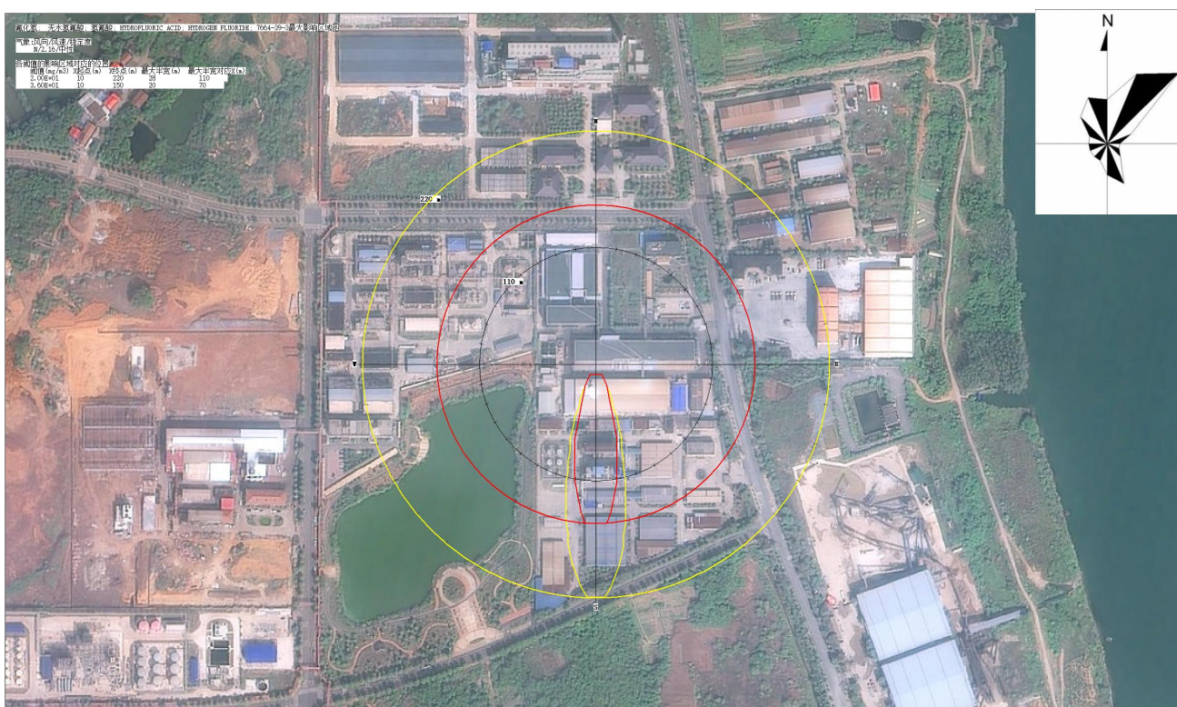
图 6.3.6-3b 氢氟酸浓度达到不同毒性终点浓度的最大影响范围示意图 (最常见气象条件)
