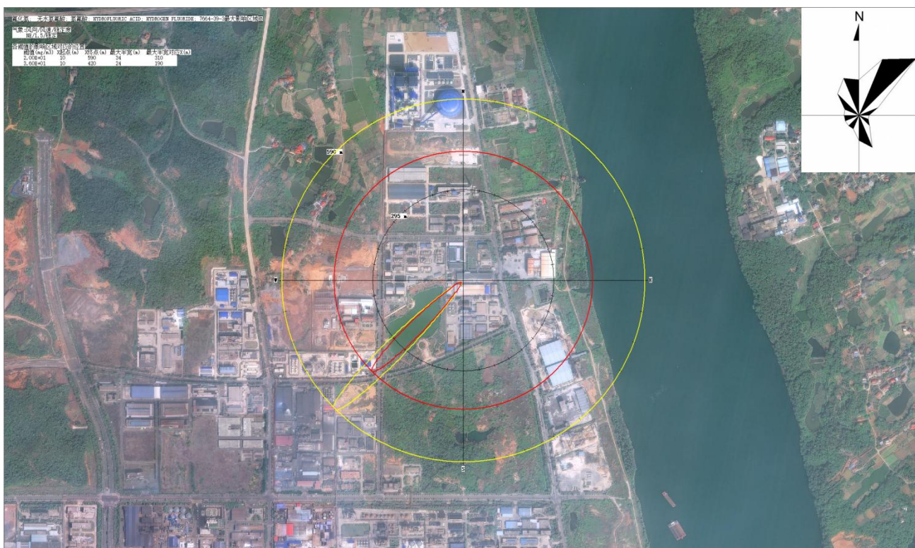
图 6.3.6-3a 氢氟酸浓度达到不同毒性终点浓度的最大影响范围示意图 (最不利气象条件)
