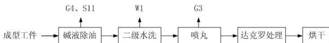
图 3.1-11 达克罗工艺产污节点图
