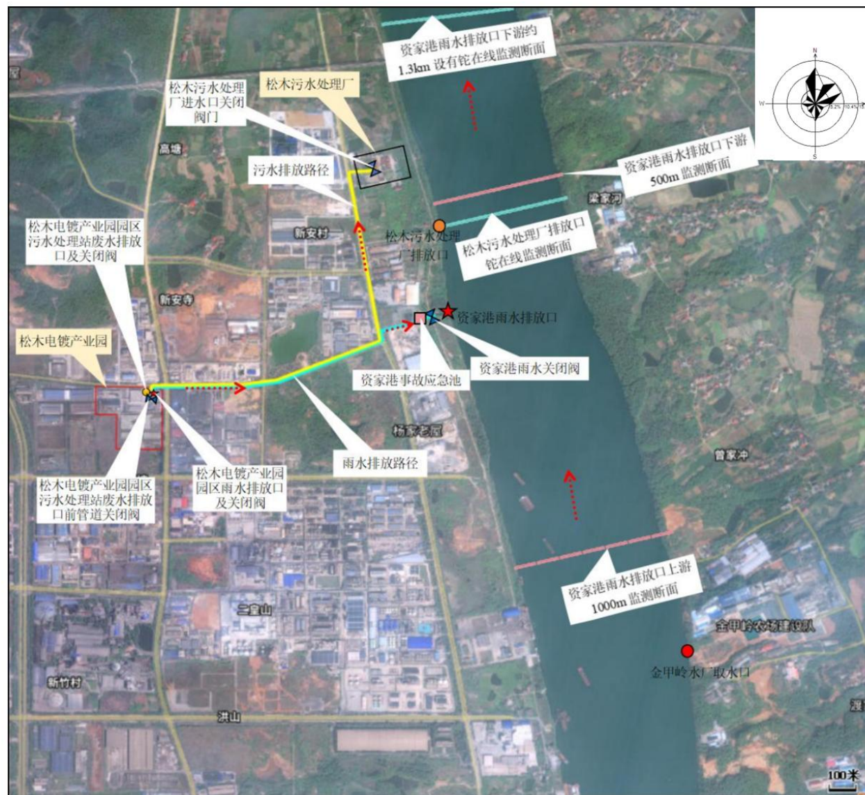
图 8.7-4 事故废水防控封堵示意图（厂外）
