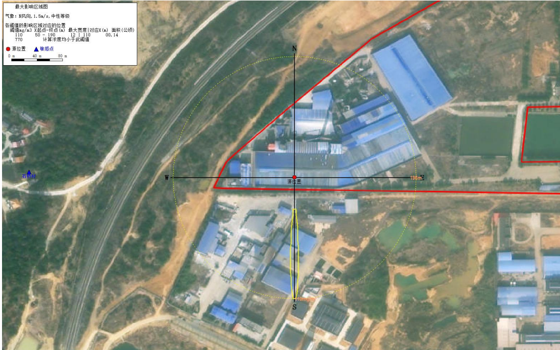
图 9.7-3 最常见气象条件下不氨水储罐泄漏大气毒性终点浓度最大范围图
