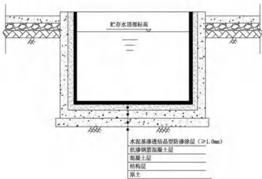
图 7.2-12 水池防渗结构示意图
