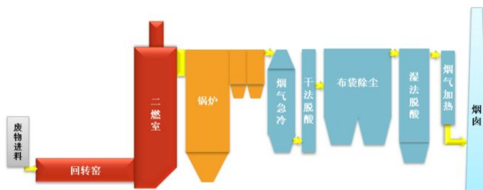
图 4.1-4 焚烧工艺设备连接及烟气处理流程图
