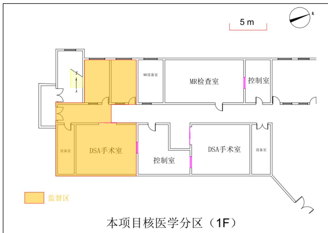
图 10-3 本项目核医学工作场所分区示意图（博爱楼一层）
