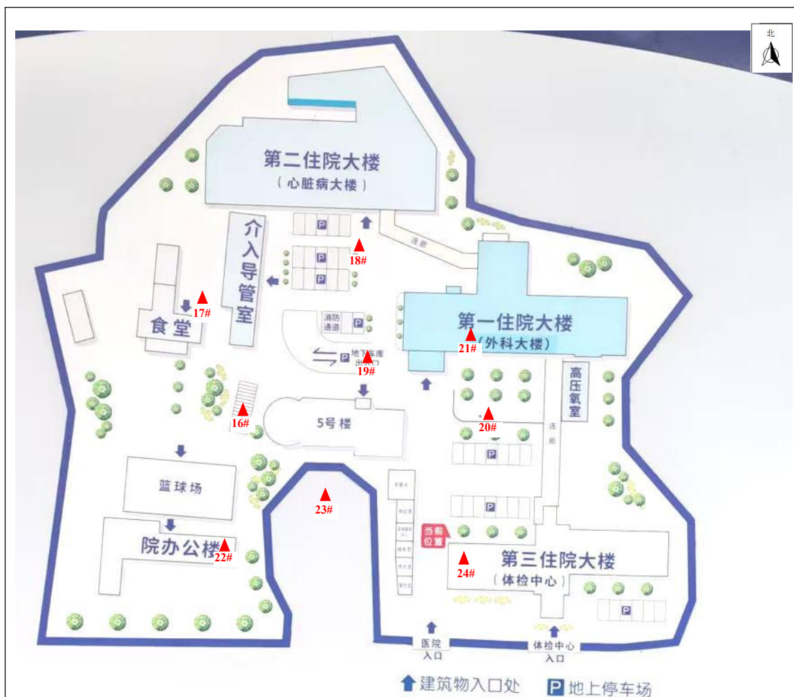
图 8-2 \gamma 辐射剂量率监测布点示意图（室外）
