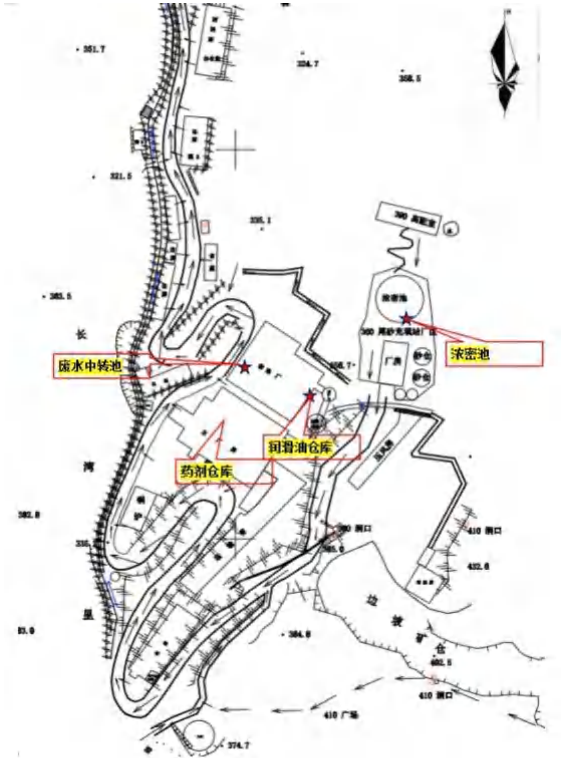
图 3.3-1 选矿厂平面布置图
