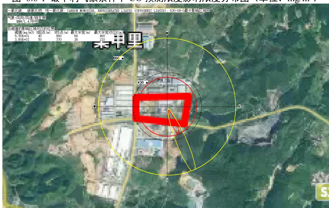
图 6.6-2 最常见气象条件下 CO 预测浓度影响浓度分布图 (单位: \text{mg}/\text{m}^3 )
