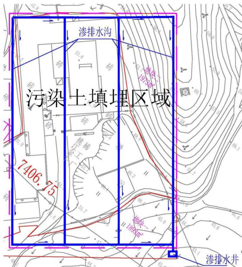
图 4.5.5-4 地下水导排系统布置图
