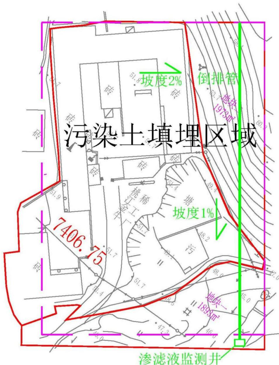
图 4.5.5-8 渗滤液设计示意图
