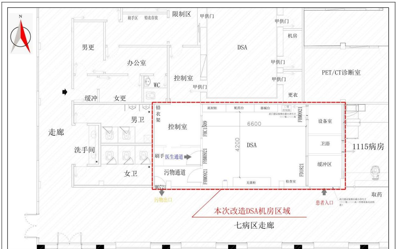
图 10-2 本项目 DSA 机房（改造后）平面布置图
