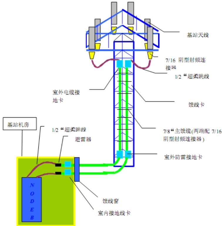
图 3-3 基站机房外设备组成
