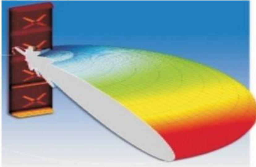
图 3-6 定向天线电磁波波束三维模拟图
