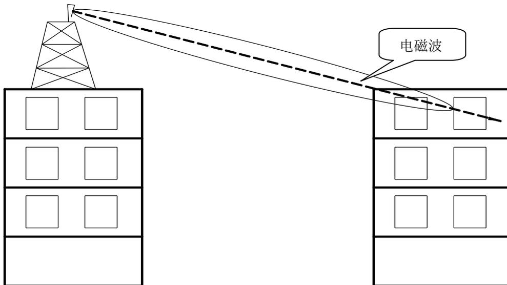
图 3-10 移动通信基站电磁辐射传播示意图
