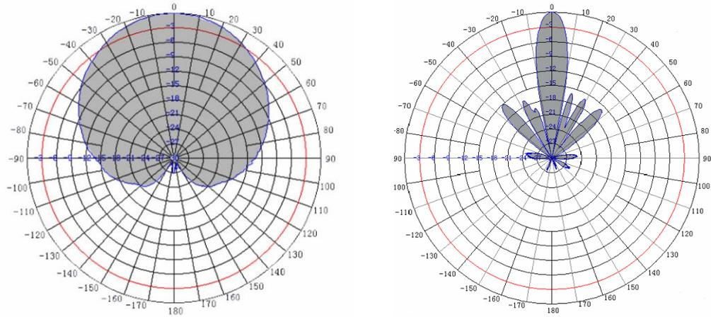
图 3-7 电磁波波束水平方向剖面图 图 3-8 电磁波波束垂直方向剖面图
