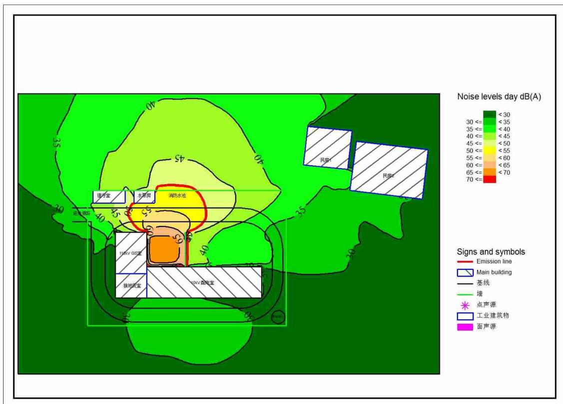
图 14 半户内布置广胜 110kV 变电站 2.8m 高处噪声影响分布图
