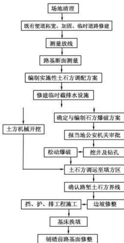
图2.10-2 挖方路基施工工艺流程
