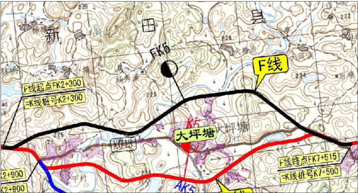
图7.3-1 路线平面图（红色-K线，黑色-F线）
