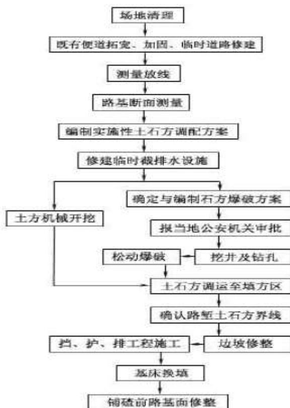
图 2.9-2 挖方路基施工工艺流程图
