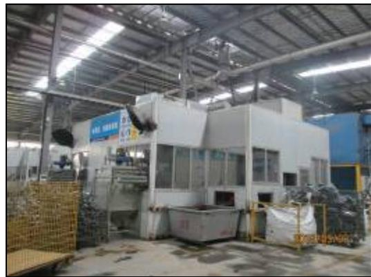
CRT 处置废气脉冲布袋除尘器
