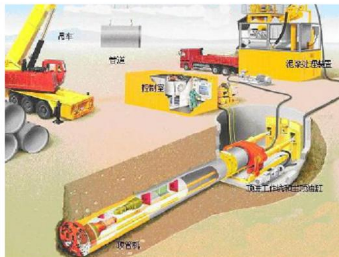
图 2.13-3 顶管施工工艺简图及立面图
