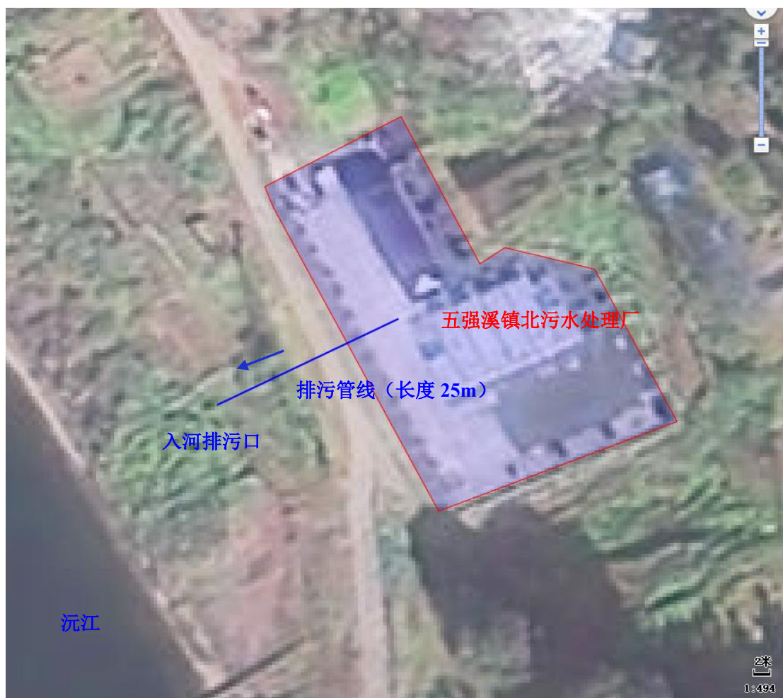
图 5.1-1 入河排污口设置的位置及入河排污线路示意图
