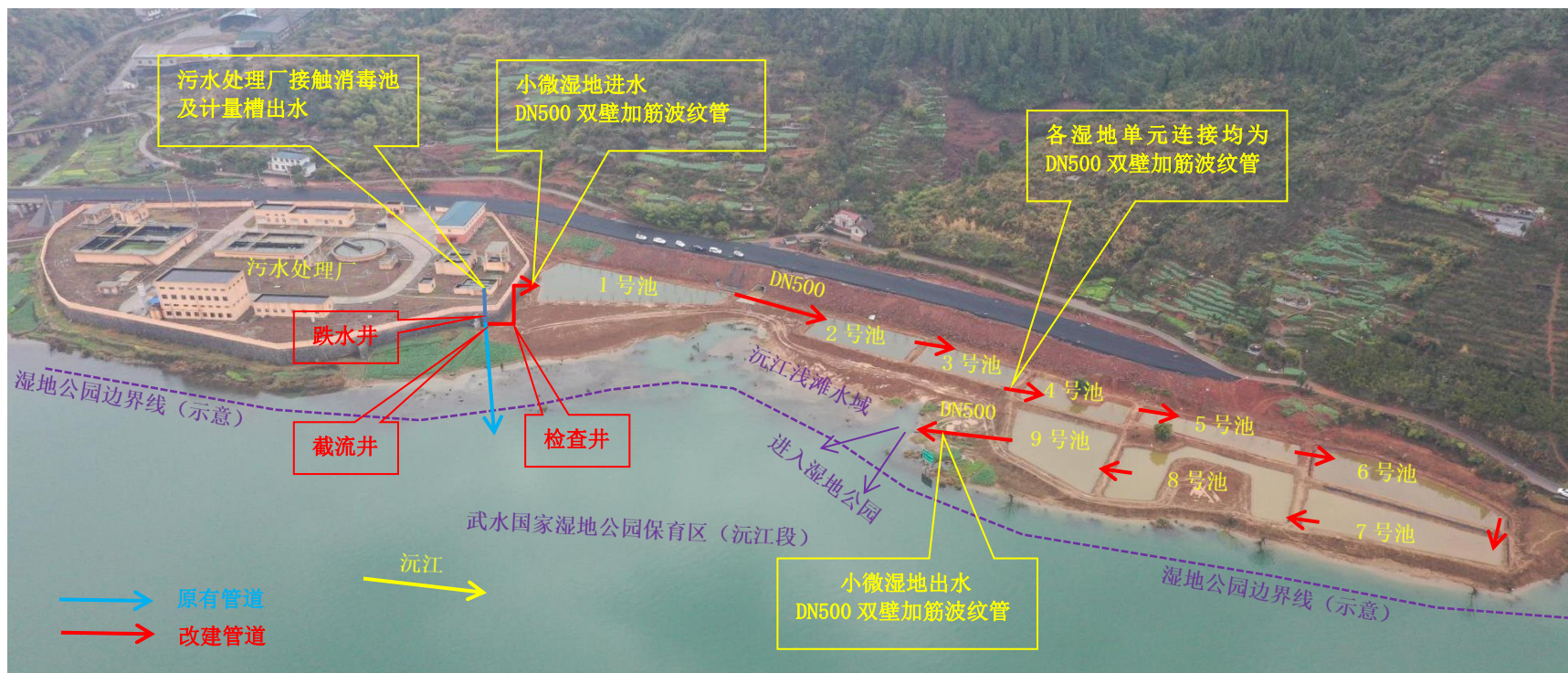
图 2.3-1 小微湿地进、出水管道连接方式及进入武水国家湿地公园路径、与湿地公园边界关系及位置示意图
