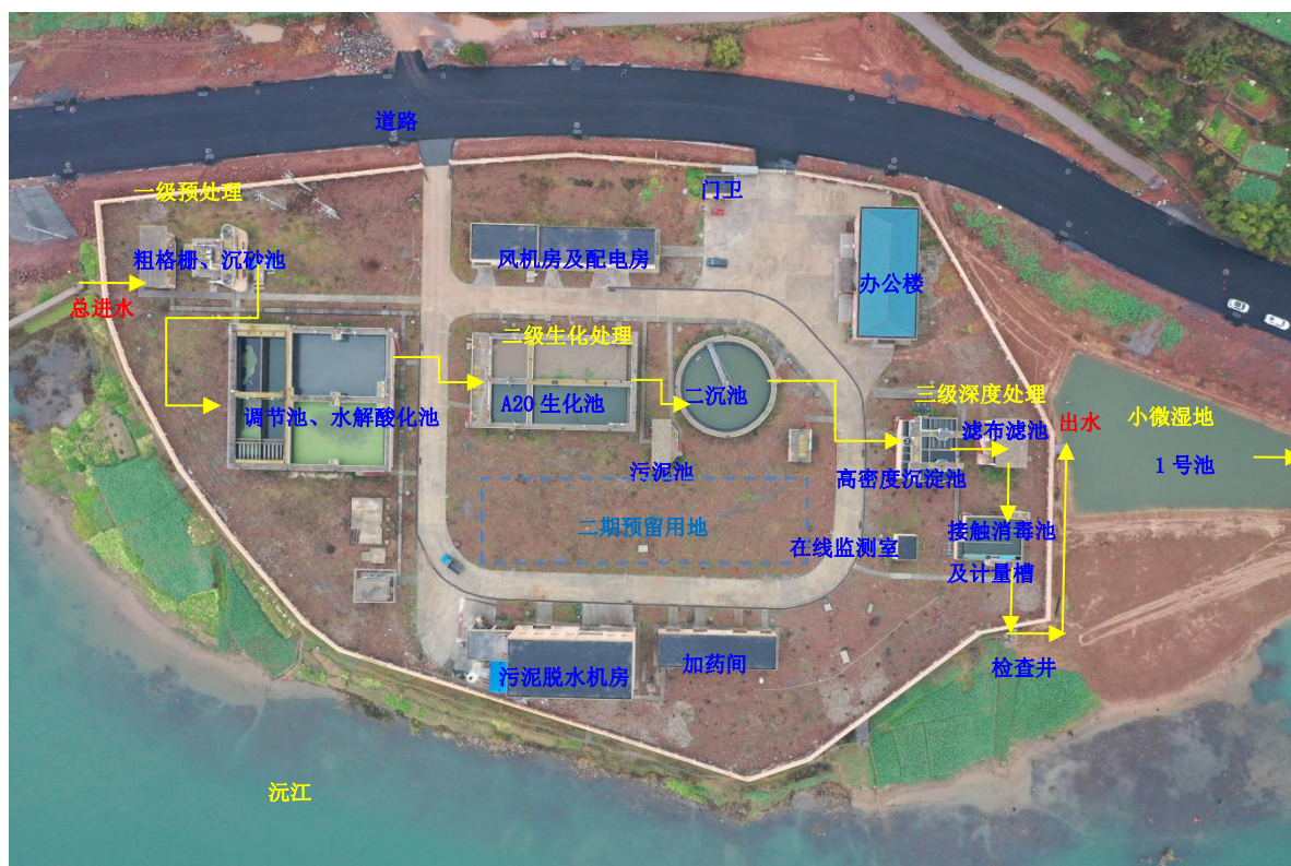
图 5.4-1 污水处理厂总平面处理流程图
