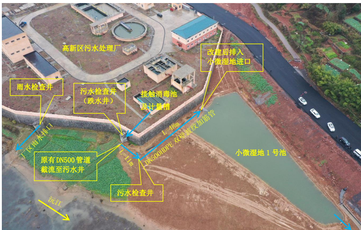
图 5.5-5 入河排污口改建后排污管走向图
