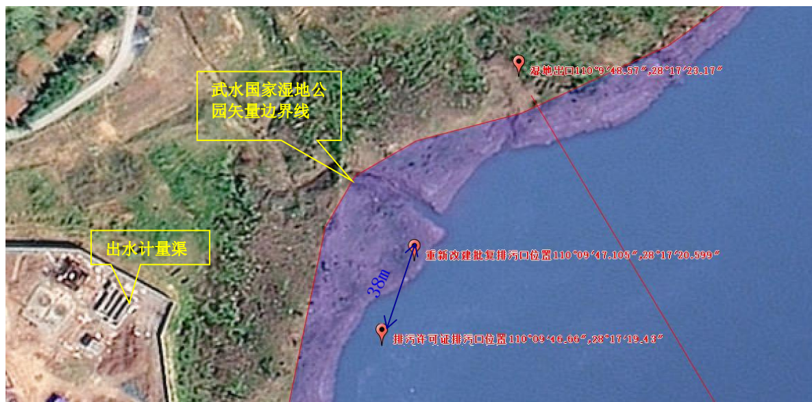
图 5.6-1 排污许可证入河排污口位置、改建后排污口及湿地出口位置关系图
