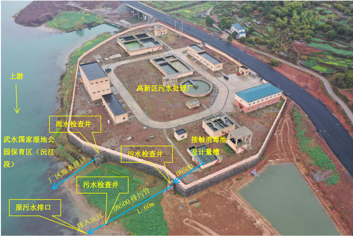
图 5.5-1 入河排污口改建前排污管走向图
