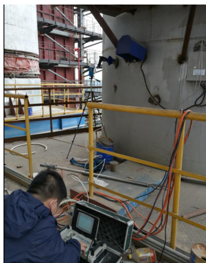
废气采样（窑尾废气）
