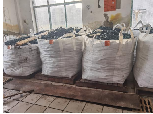
危险废物暂存间（含铬污泥）
