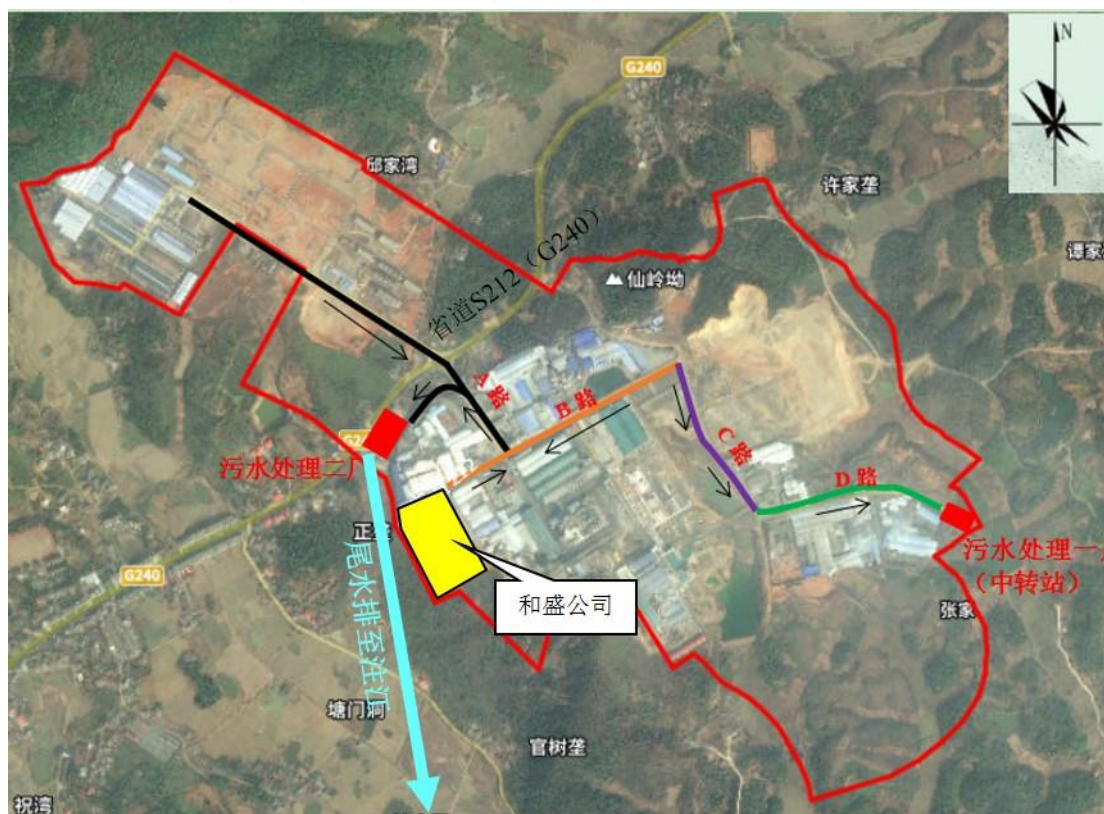
图 2.7-1 太和工业园雨污管道干管分布图
