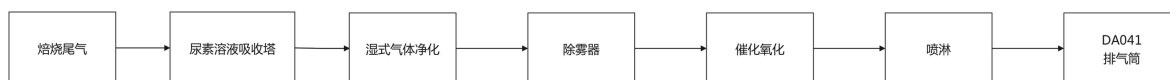
图 4.2-4-2 失活环己酮氨肟化分子筛再生工艺废气收集、处理、排放示意图
