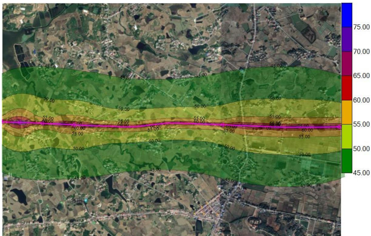
图 5.4-7 项目路段四 (DK12+000 至 DK16+475) 噪声预测等声级曲线图
