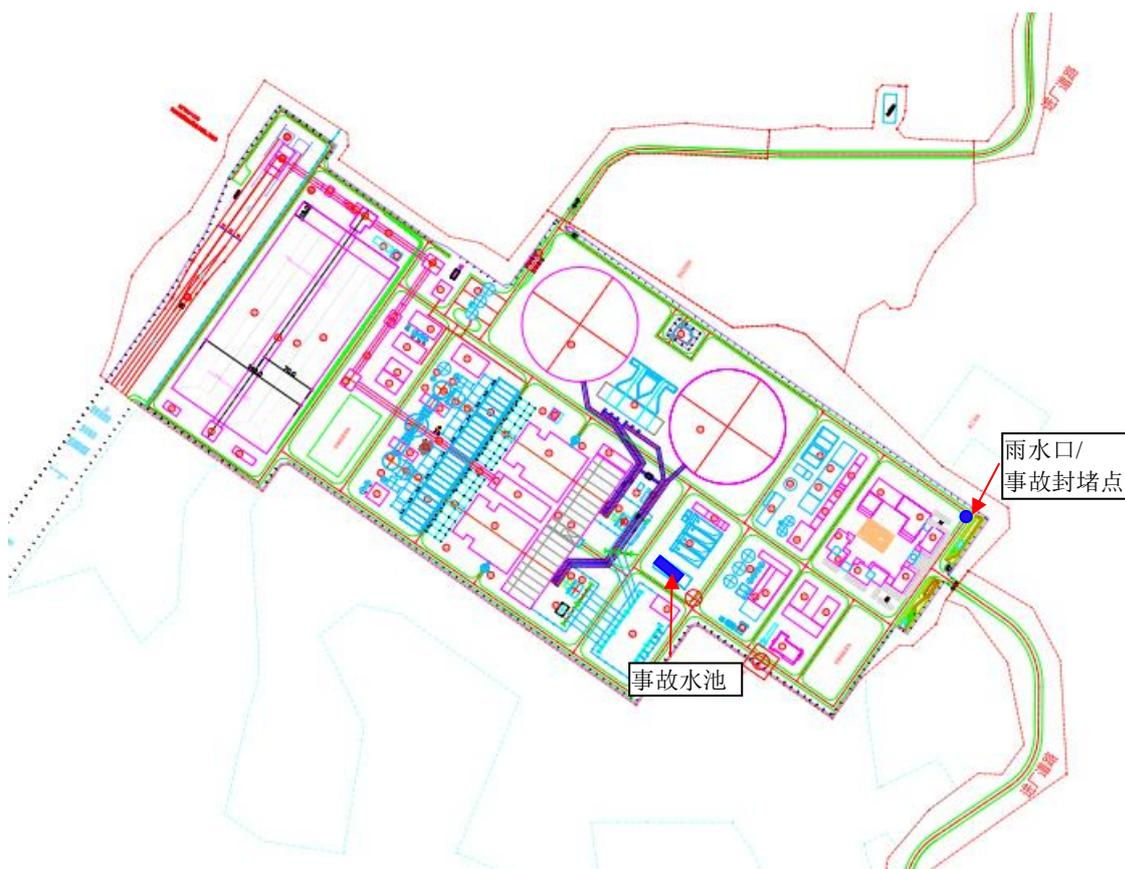
图 7.6-2 事故水封堵示意图
