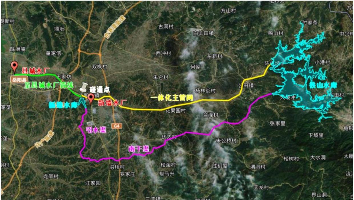
图 4.4-3 输水管线线路示意图
