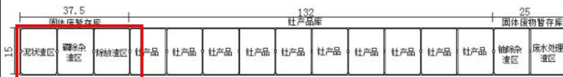
图 2-11 固体废物暂存库平面布置示意图
