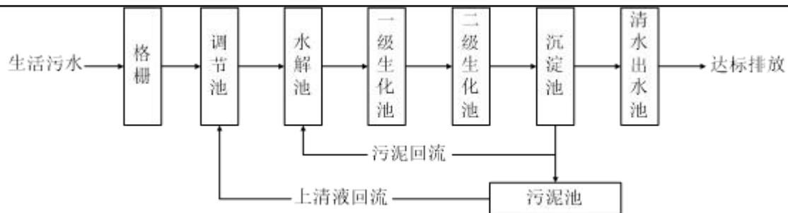
图 2-17 二七二铀业公司生活污水处理设施处理工艺流程图
