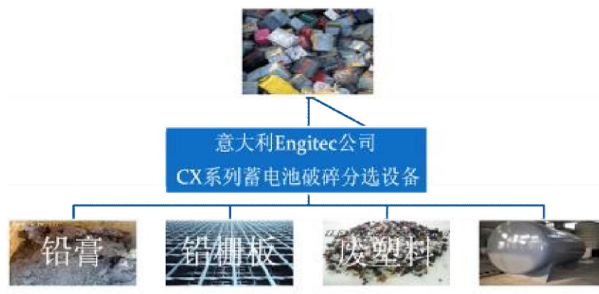
图 3.4-1 蓄电池拆解示意图
