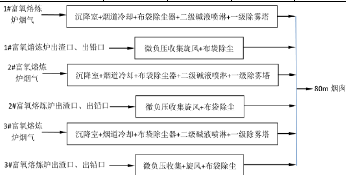
图 4.9-1 恒晟公司熔炼炉废气处理及排放路径图
