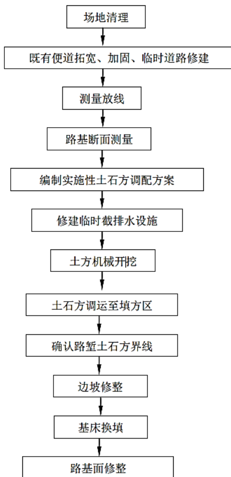
图2.9-2 路堑施工工艺流程图
