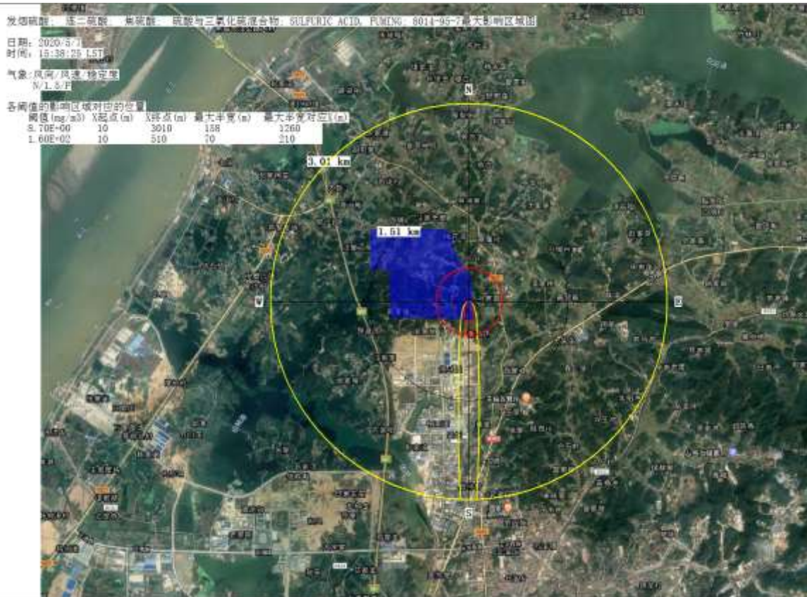
图 8.3-17a SO 3 预测浓度达到不同毒性终点浓度的最大影响范围示意图 (最不利气象条件)
