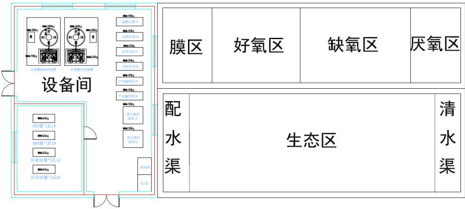
图 8.3-4 服务区 E-MBR 中水回用系统平面布置图
