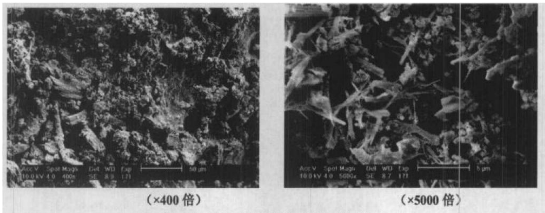
图 9.4-2 不同放大倍数下炉渣电镜扫描图
