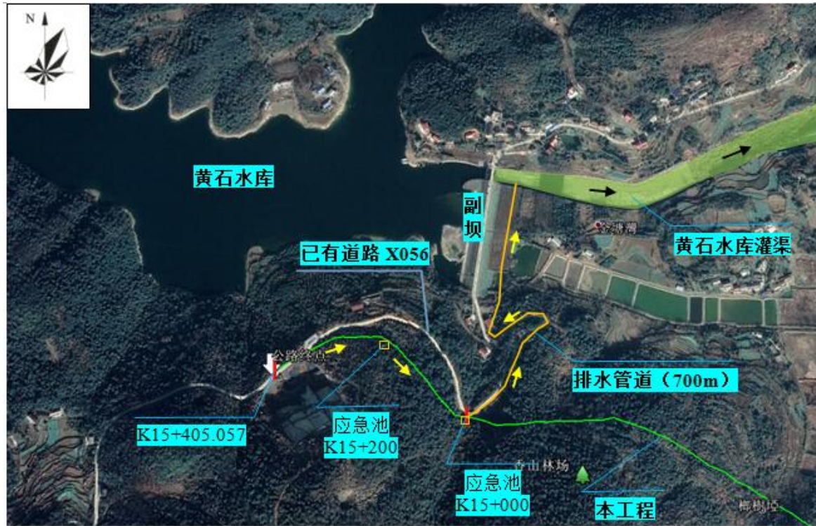
图 4.2-1 第二段 K15+000~K15+405.057 段路面径流排水路径示意图
