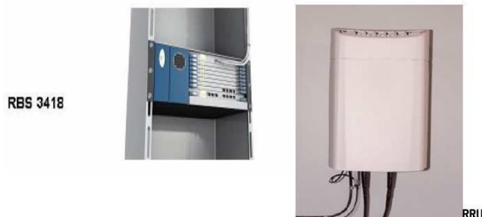
图 3-5 分布式基站的收发信机
