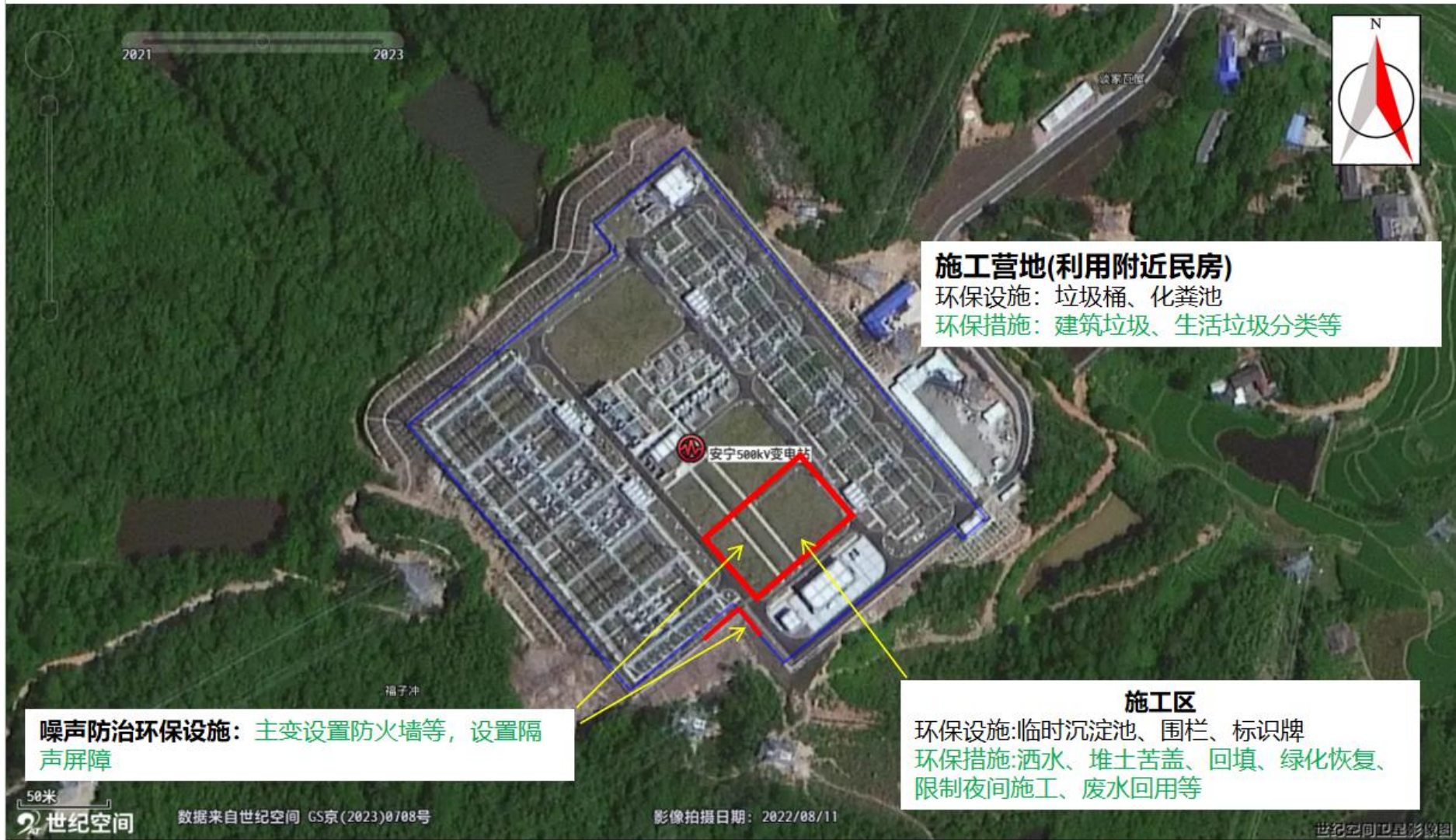
附图 6：湖南长沙安宁 500 千伏变电站第 2 台主变扩建工程环境保护设施、措施布置示意图
