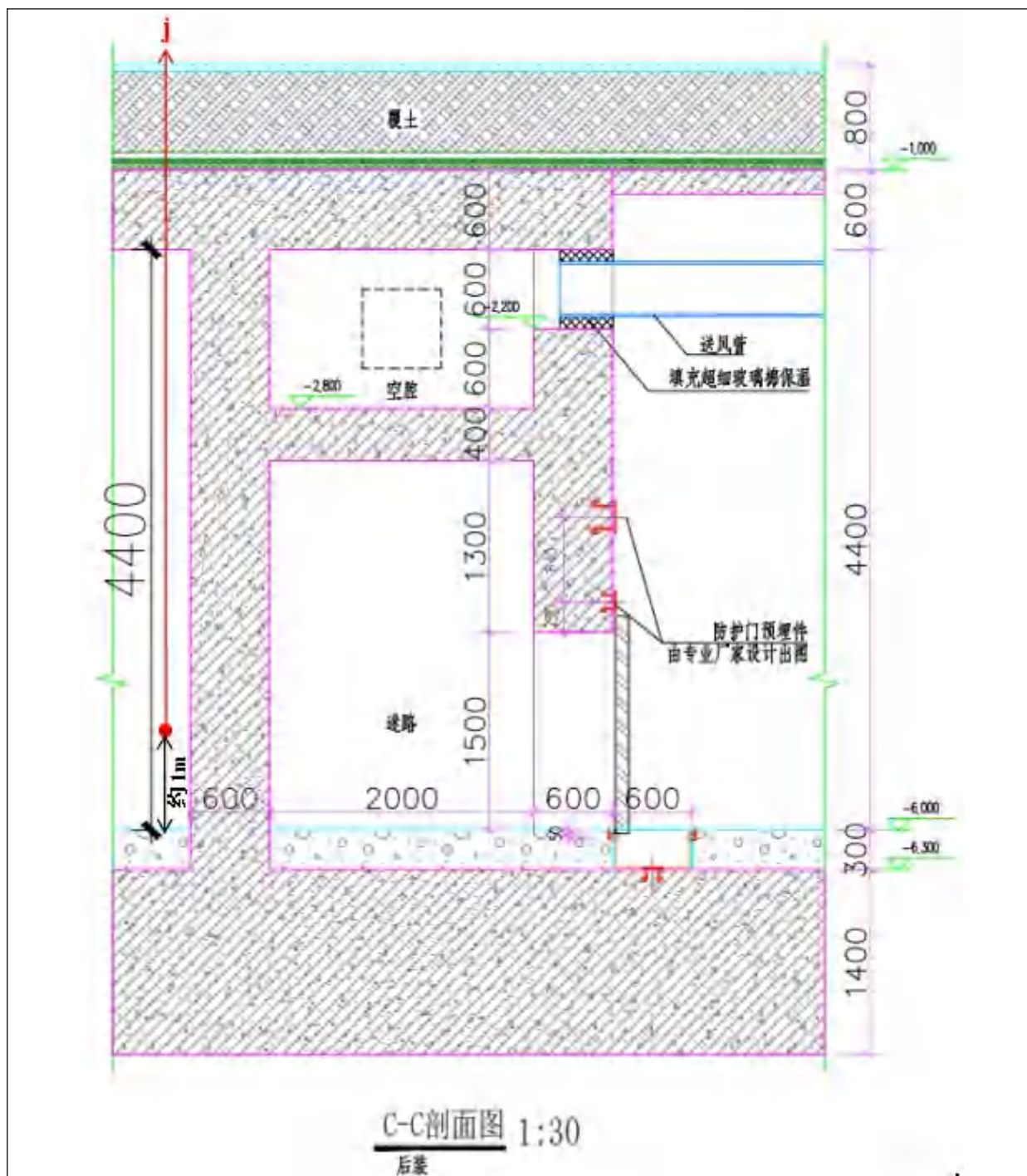
图 11-4 后装治疗机房关注点示意图（剖面）
