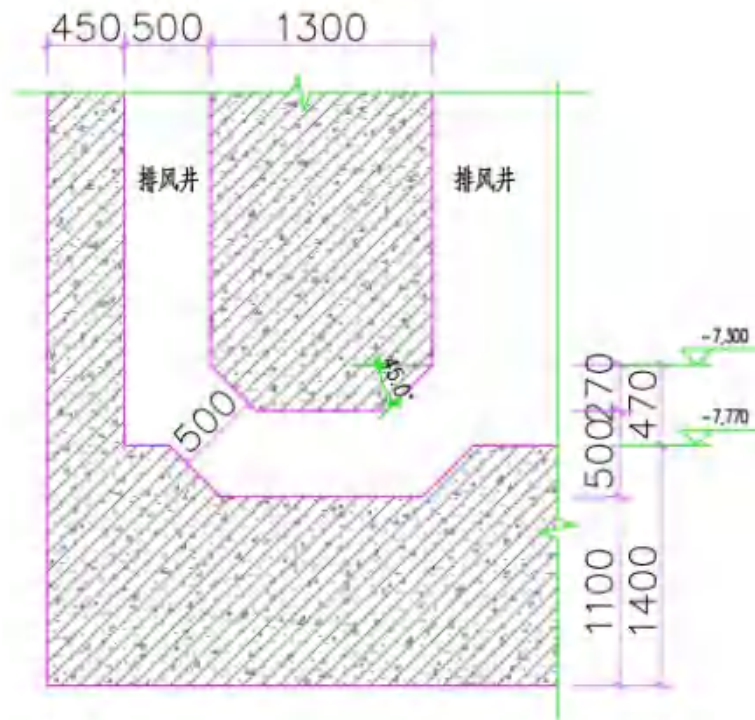
④ 排风穿防护墙剖面图 1:30 直线加速器室
