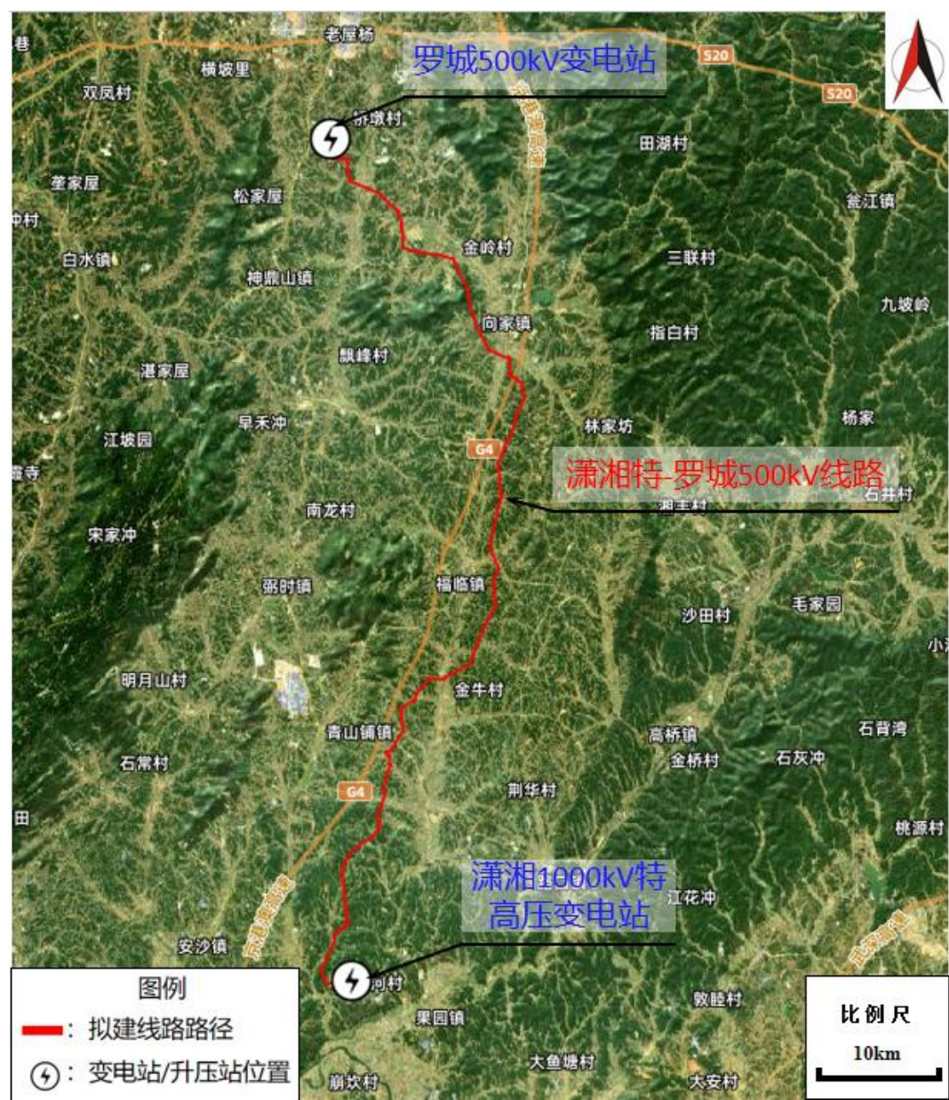
图 3-6 潇湘特-罗城 500kV 线路路径图
