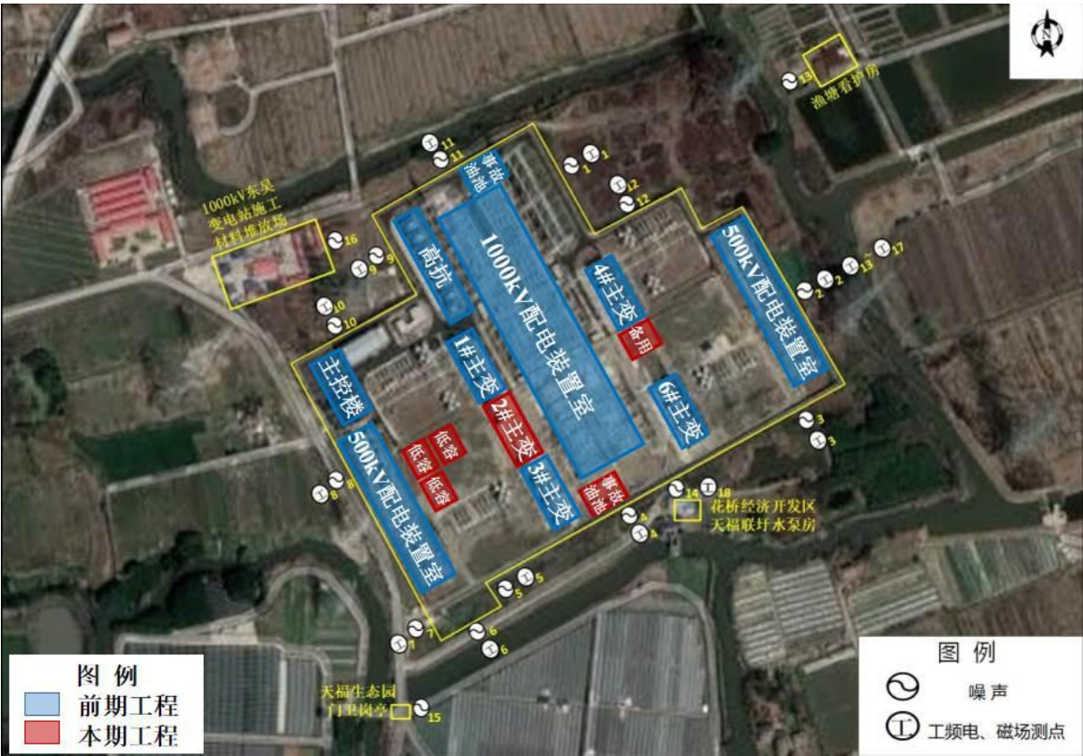
图 6-1 东吴 1000kV 变电站平面布置及厂界电磁环境监测点位示意图
