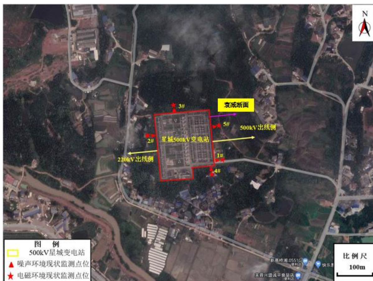
图 6-1 星城 500kV 变电站厂界及衰减断面电磁环境监测点位示意图
