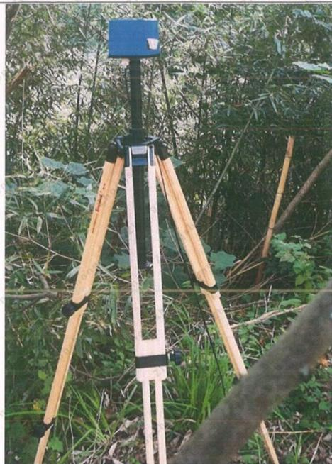
附图 1-1 工频电磁场强度检测照片
