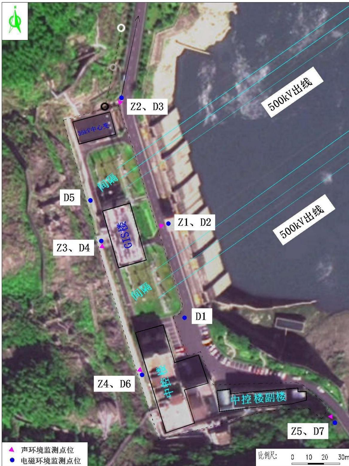
图 6-5 类比开关站平面布置及监测点位图
