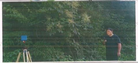
附图 1-14 工频电磁场强度检测照片
