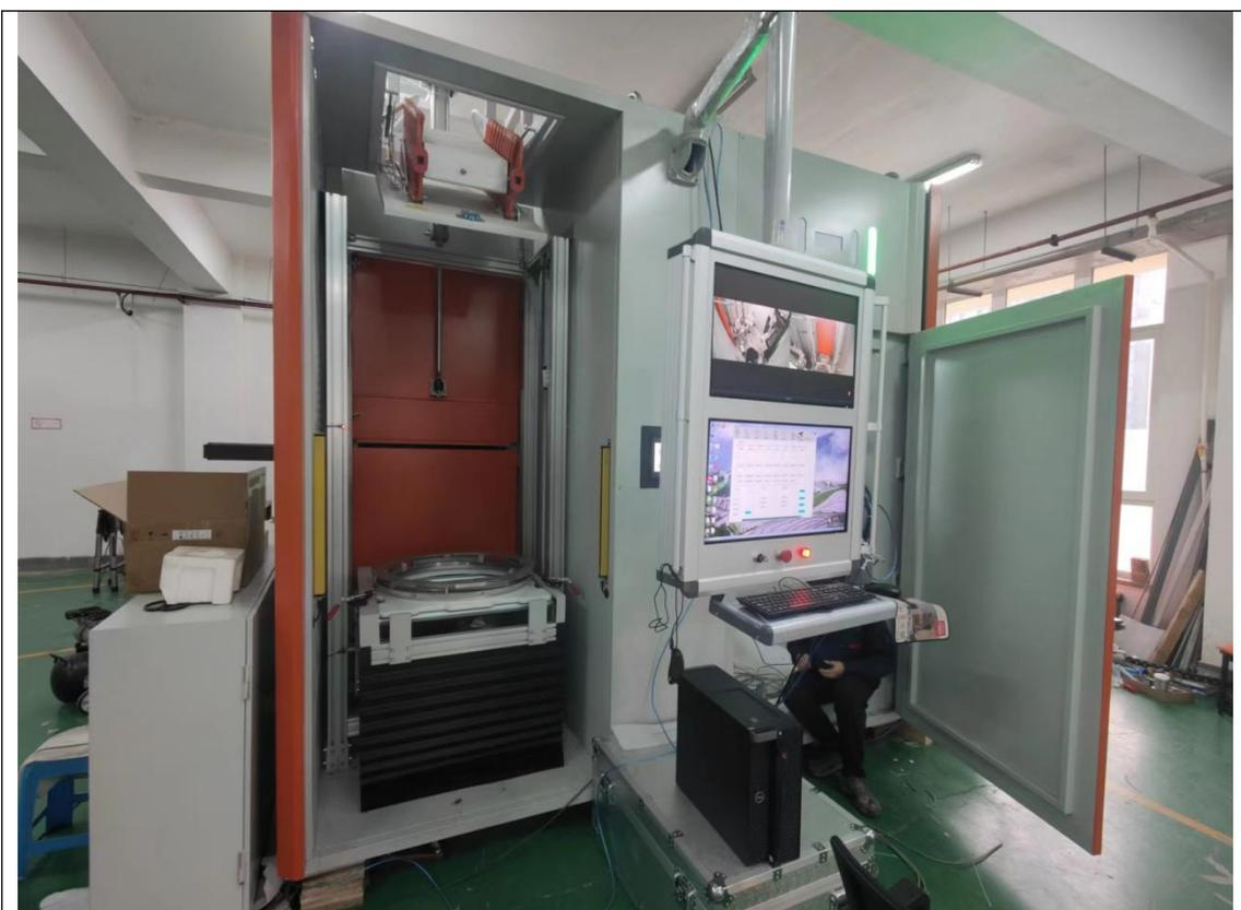
图 9-5 DR 数字射线自动检测系统实物图
