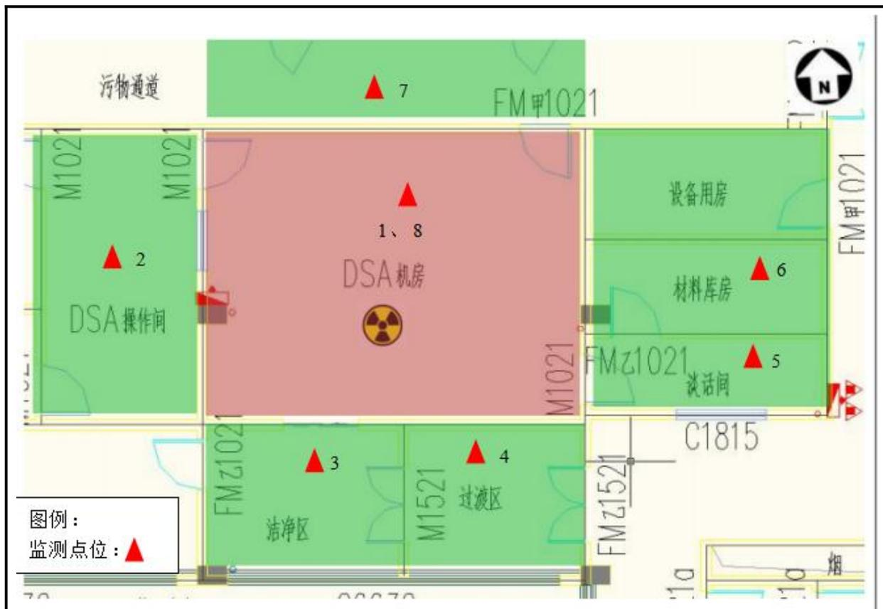
图 8-1 DSA 机房辐射环境背景监测布点示意图
