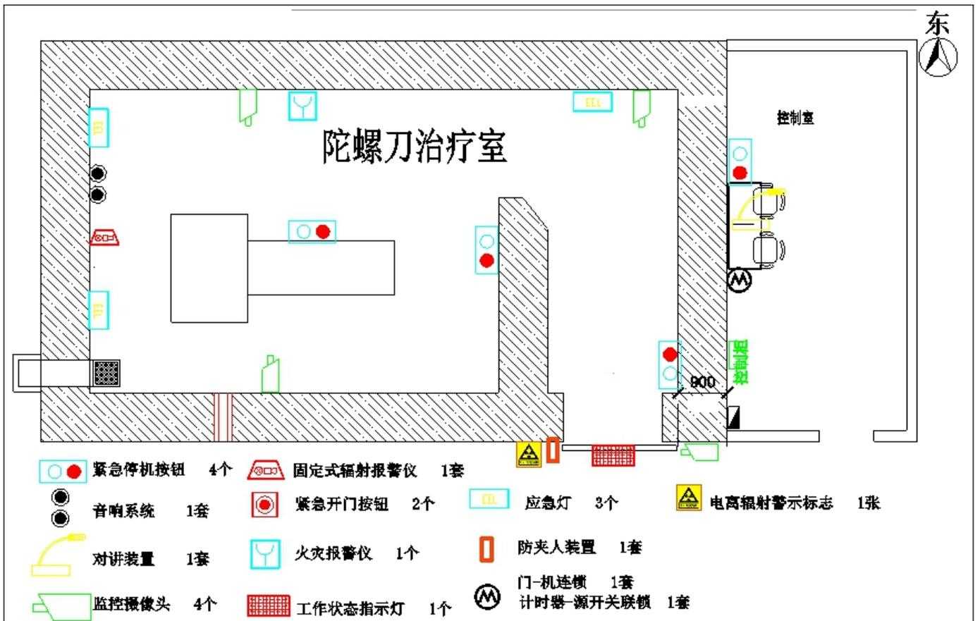
图 10-4 陀螺刀机房辐射安全防护与环保设施配置图
