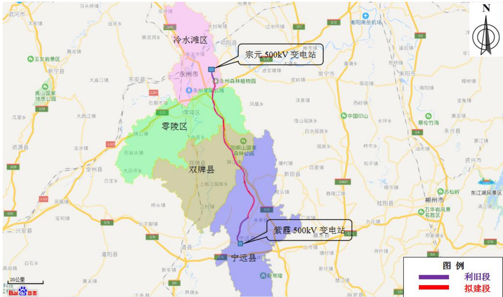
图 3-1 湖南永州宗元~紫霞第二回 500kV 线路工程地理位置及线路路径示意图
