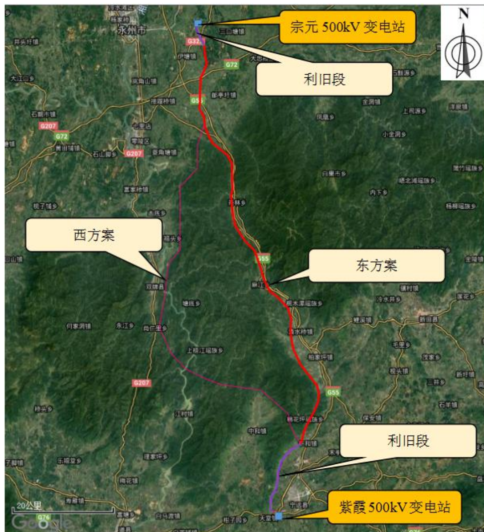
图 3-8 湖南永州宗元~紫霞第二回 500kV 线路工程东、西路径方案示意图
