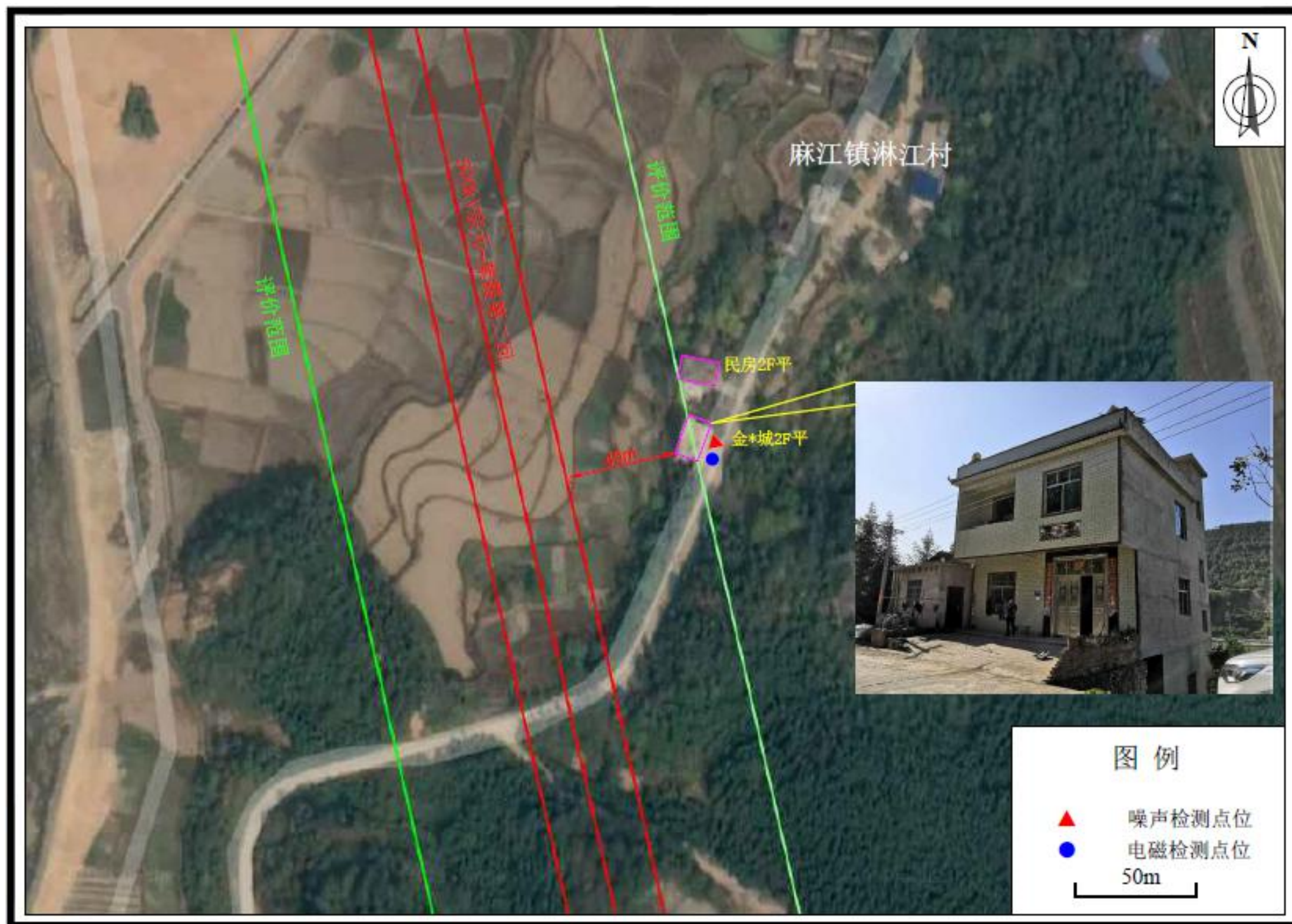
附图3-22 500kV宗元~紫霞第二回线路麻江村敏感点分布及检测布点示意图
