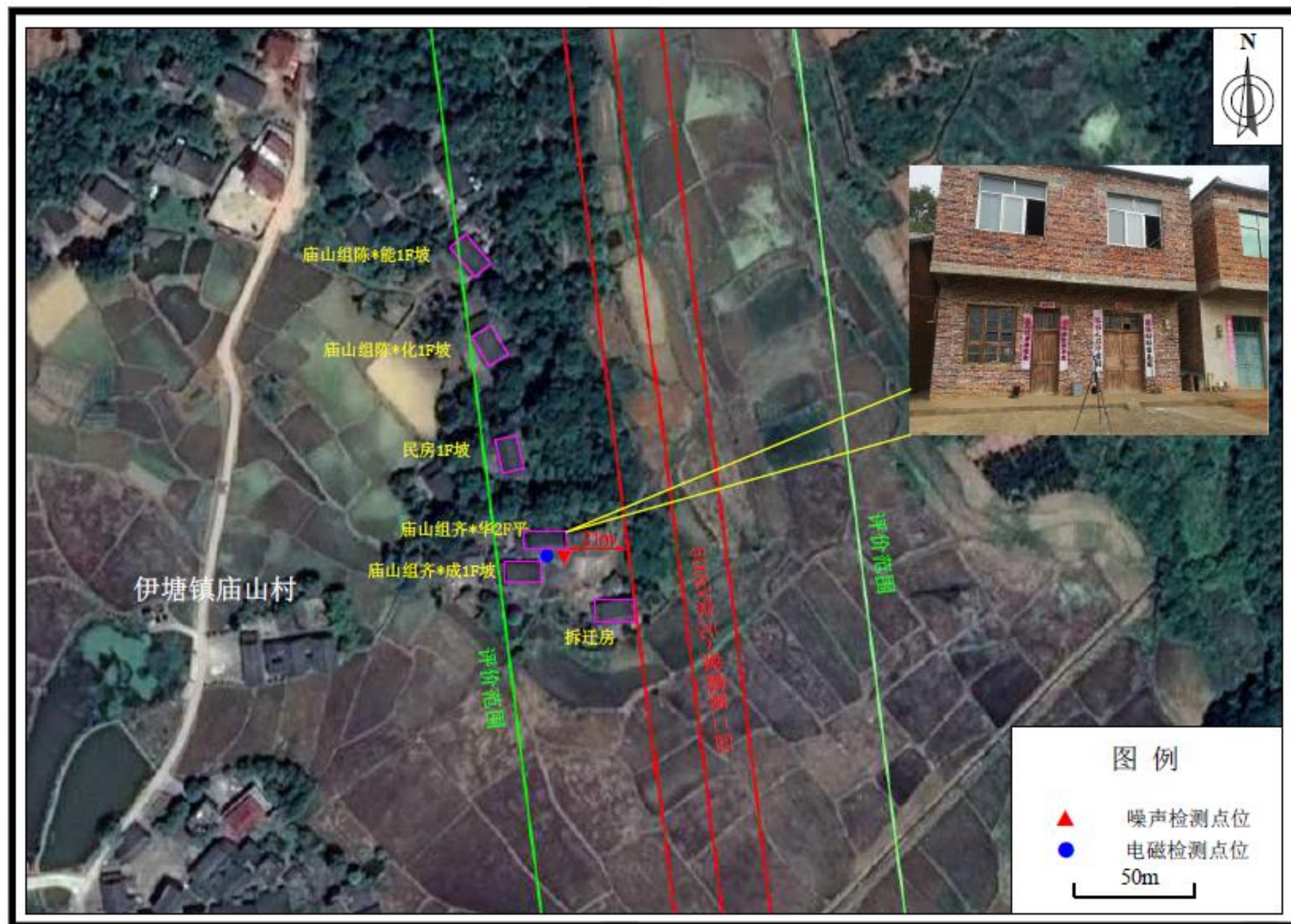
附图3-3 500kV宗元~紫霞第二回线路庙山村敏感点分布及检测布点示意图
