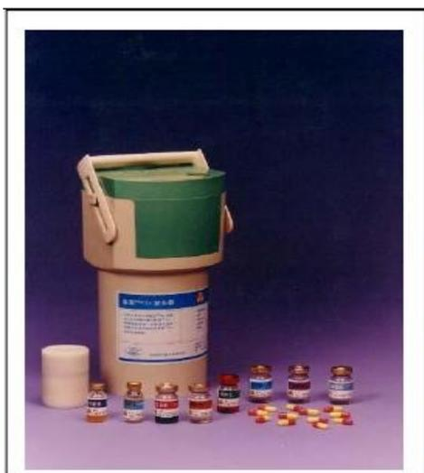
图 9-2 (a) <sup>99</sup>Mo—<sup>99m</sup>Tc 发生器实物图
