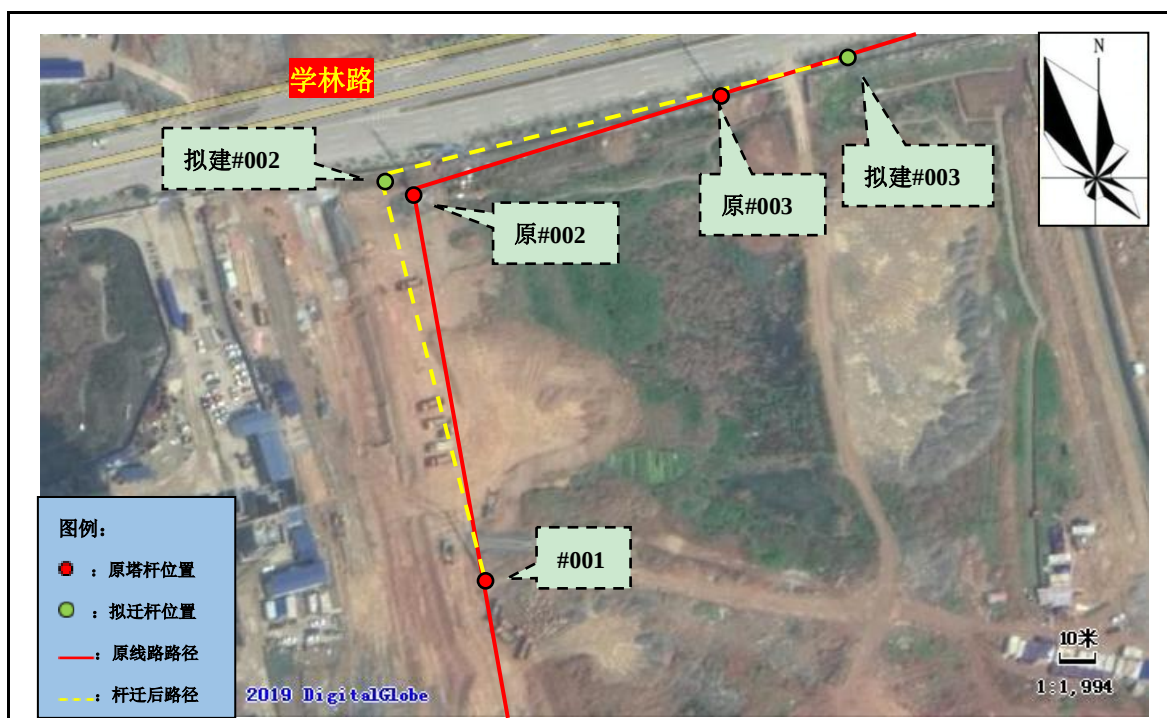
图 1-1 原线路走向及新建线路相对位置示意图
