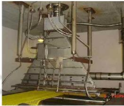
图9-3 加速器辐照室
