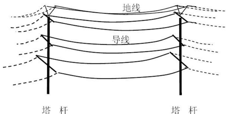
图4高压输电线路基本工艺示意图
