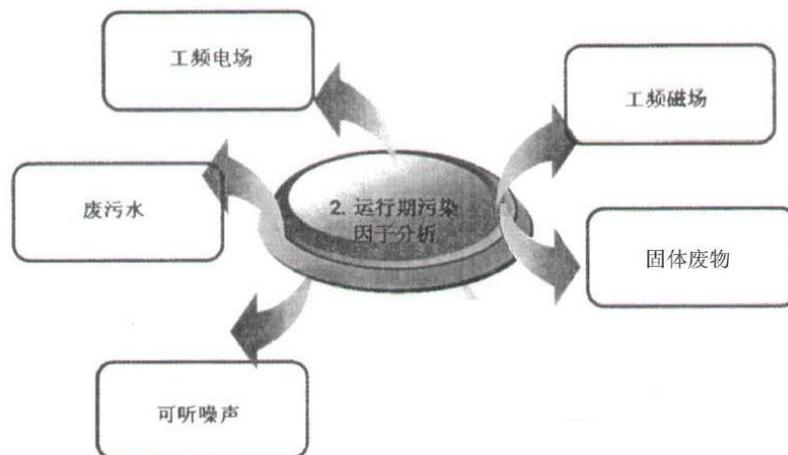
图3变电站运行期污染因子分析示意图
