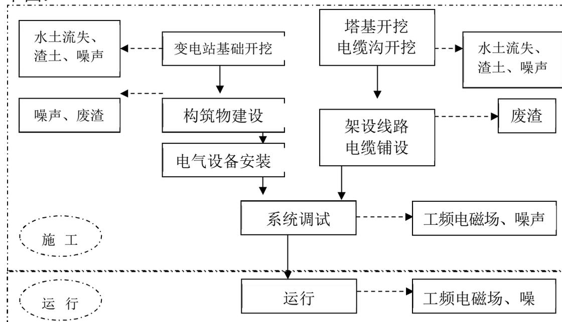
图 1 输变电工程建设流程和产污节点图
